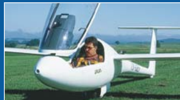
SCHÖNHEIT aus Litauen: Die LAK 17a mit Wingtips in der 18-m-Version. In den Details zeigt sich das Flugzeug auf dem aktuellen Stand der Technik.
